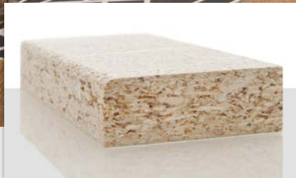
1. Eine grobstrukturierte Mittelschicht lässt die Ummantelung einer Spanplattenkante mit dünnen Papierfolien nicht zu.
