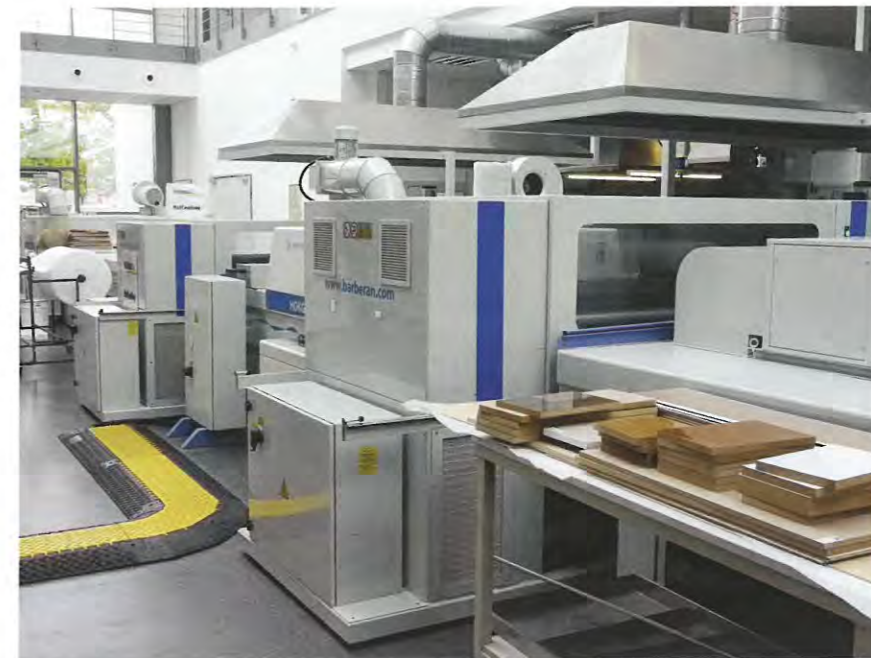
„Hot Coating“-Technikumsanlage in Weingarten, vorne Musterplatten
